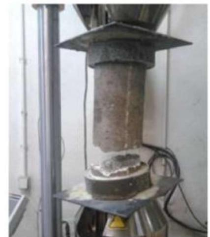
Figure 3. Comportement cyclique d'un échantillon cylindrique de béton EPS
